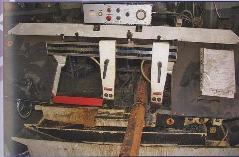
Механическая пила. Резка круглого металла диаметром до 300 мм.
