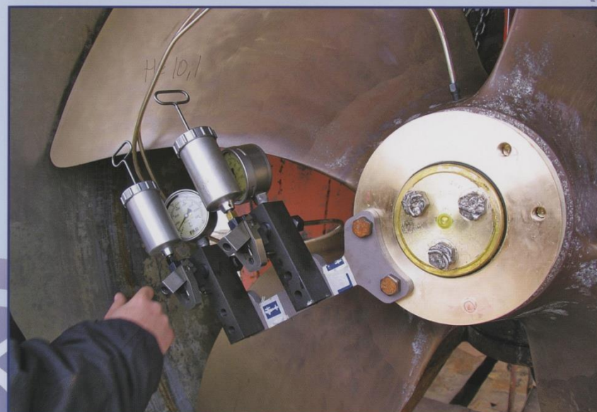
Гидропрессовое приспособление для спрессовки и напрессовки гребных винтов.
