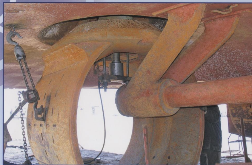
Спрессовка насадки с конуса баллера гидропрессовым способом.
